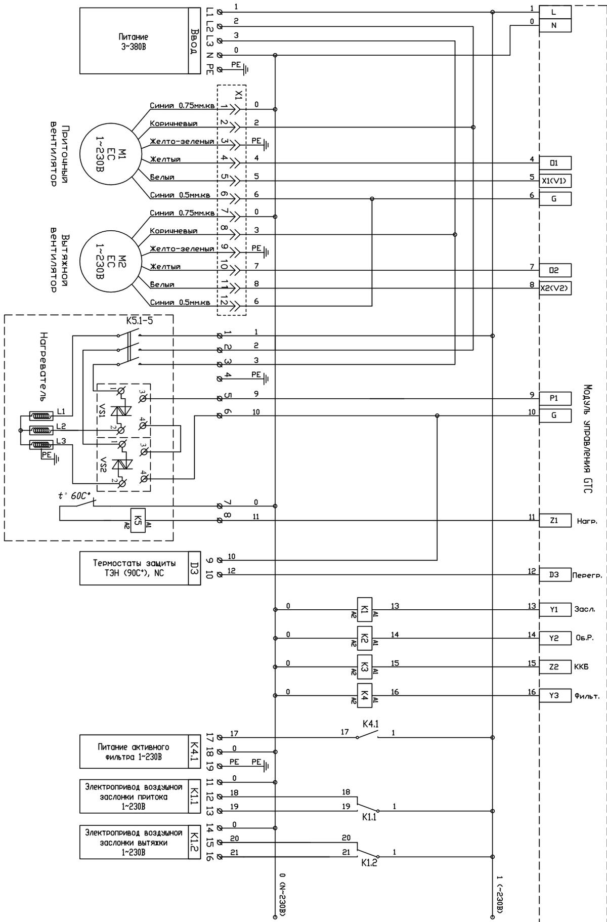
Схема подключения: **Brissago-EC HPE 450, Brissago-EC HPE 850**
