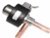
EEV Saginomiya (Япония) с запатентованным алгоритмом управления обладает высокой точностью регулировки (500 промежуточных положений), позволяет организовать динамическое согласование системы охлаждения, снизить энергопотребление агрегата и более точно поддерживать требуемый температурный режим в помещении.
