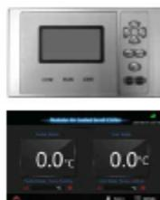
Управление осуществляется с выносного пульта управления в стандартном исполнении или с 9" сенсорного экрана (touch screen), которые имеют в своем составе интерфейсные выходы RS-485 для диспетчеризации по открытому протоколу ModBus. Каждый пульт может управлять как индивидуальной установкой, так и группой до 16 чиллеров.
